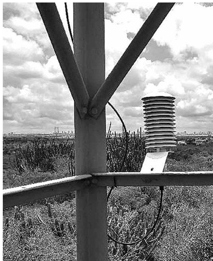
Trinta e quatro sensores em uma torre de 15 metros e no solo, próximo a ela, captam as informações que alimentam o banco de dados
